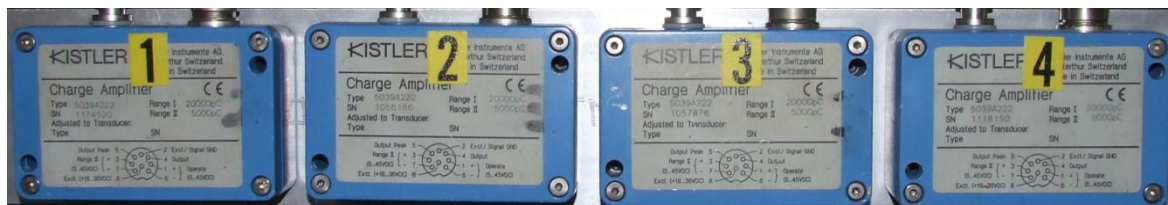
41. ábra. A töltéserősítők (4 csatorna)
