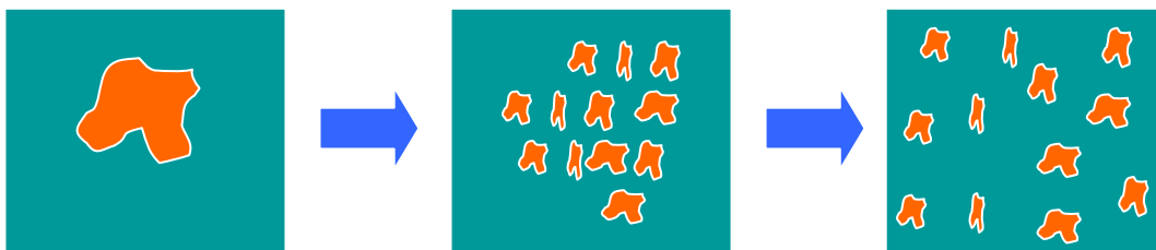
1. ábra. A diszperzív és a disztributív keverés elve
