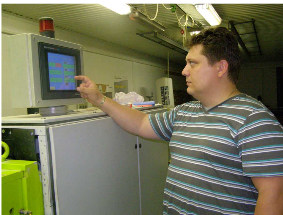
A szabályozó PLC-n a tömörítési paraméterek beállítása
