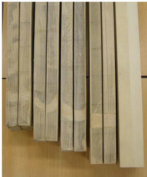
A mintadarabok végeinél jól látható a maradó alakváltozás
