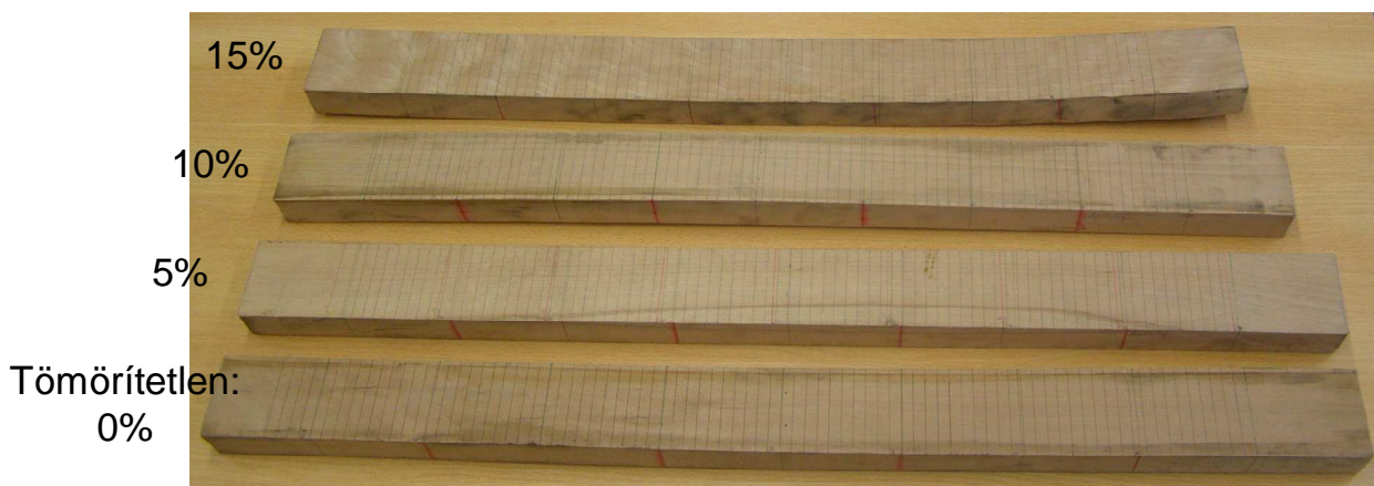
A 3. tömörítés mintadarabjai az ultrahangos vizsgálat után, jól láthatók a 10 mm-es beosztások a hossz tengely mentén (az ábra Sándor Balázs diplomavédéséből való)
