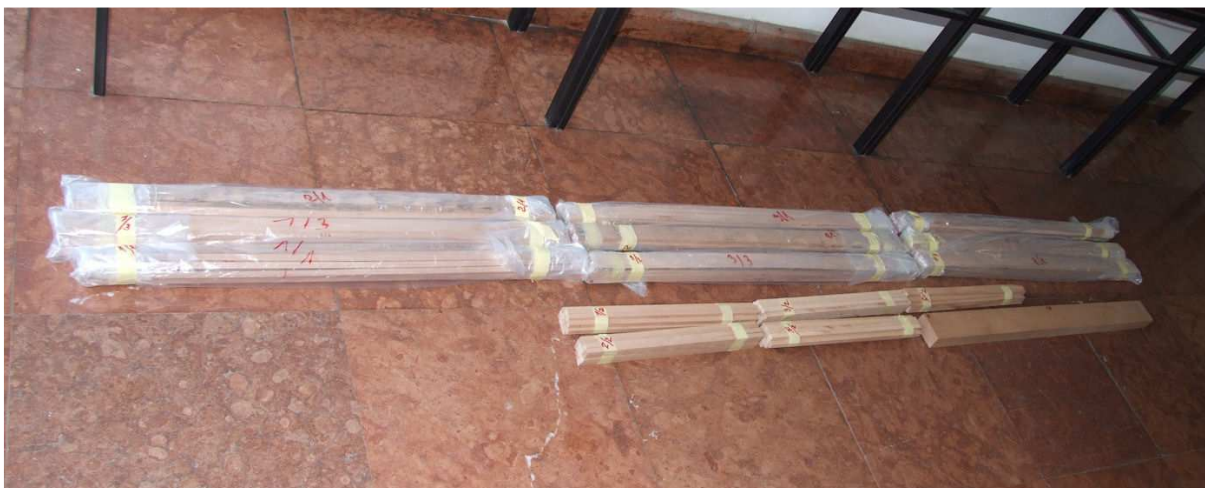
A második tömörítés feldarabolt bükk mintadarabjai
