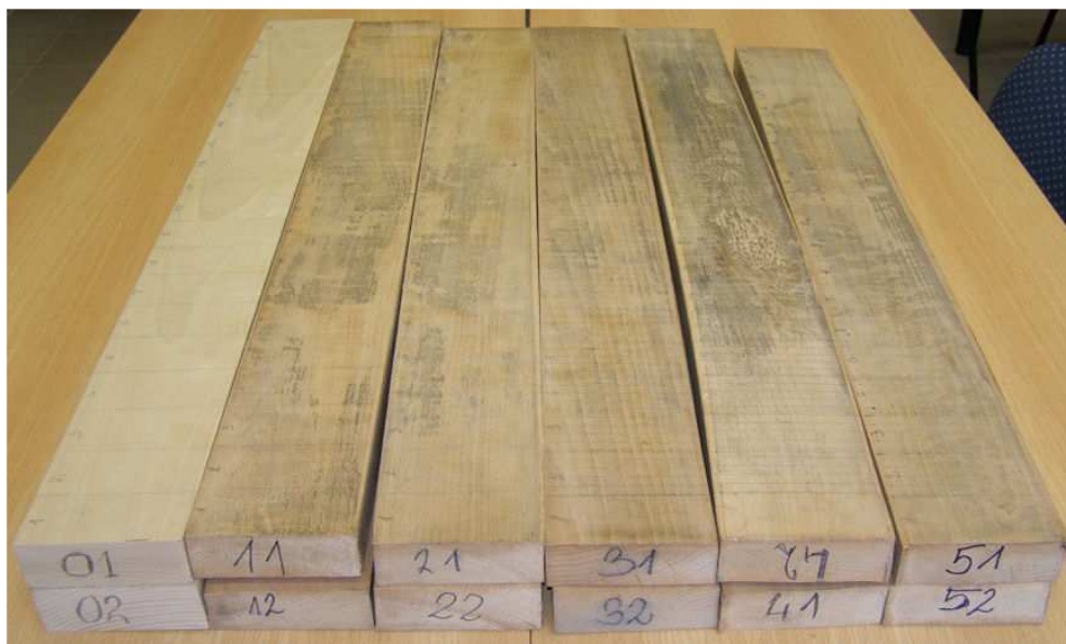
Mintadarabok roncsolásmentes mérés előtt
