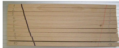
Mintadarabok pálcákra vágva hajlításhoz
