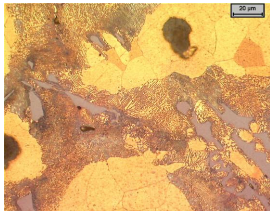
4.27. ábra. A 12-es jelű minta fénymikroszkópos felvétele 30 másodperces maratás után (Eredeti nagyítás: 500x, Beraha Na-Mo II. reagens)
