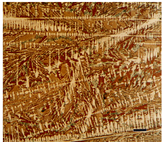
3.21. ábra. Hipoeutektikus szürke öntvény mikroszkópos felvétele Beraha szelénsavas reagenssel történő maratás után (nagyítási lépték: 100\mu\text{m} ) [42]
