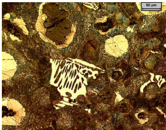
4.30. ábra. Öntöttvas minta fénymikroszkópos felvétele korróziós maratás után (Eredeti nagyítás: 200x, Nital)
