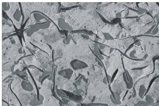
3.1. ábra. Lemezgrafitos öntöttvas pásztázó elektronmikroszkópos felvétele (szekunder elektron=SE, eredeti nagyítás: 500x) [14]
