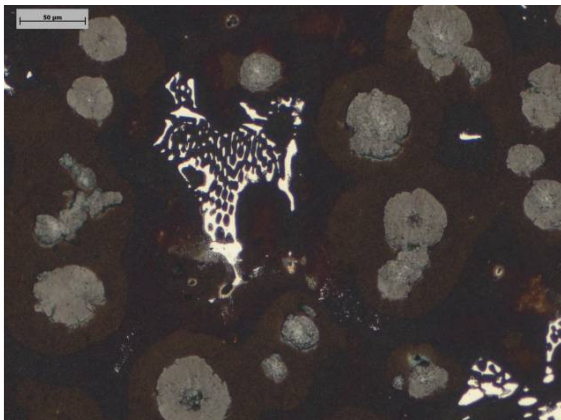
4.13. ábra. A 12-es jelű minta fénymikroszkópos felvétele 25 másodperces maratás után (Eredeti nagyítás: 200x, kálium-metabiszulfid reagens)
