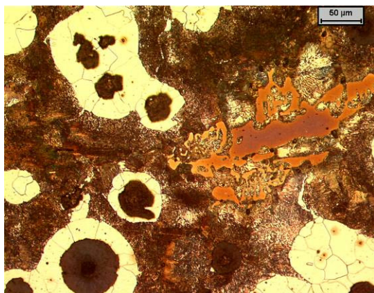
4.28. ábra. A 12-es jelű minta fénymikroszkópos felvétele 15 másodperces maratás után (Eredeti nagyítás: 200x, Nital, Beraha Na-Mo I. reagens)
