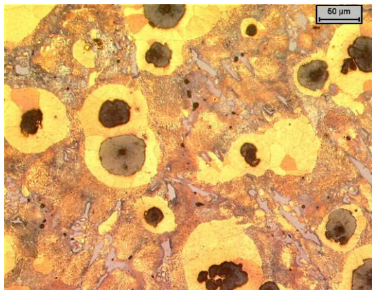
4.26. ábra. A 12-es jelű minta fénymikroszkópos felvétele 30 másodperces maratás után (Eredeti nagyítás: 200x, Beraha Na-Mo II. reagens)
