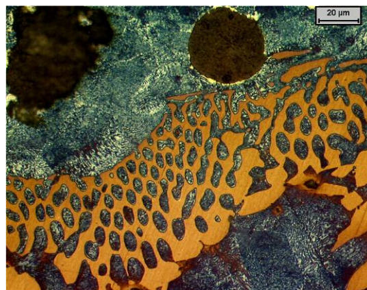
4.18. ábra. A 15-ös jelű minta fénymikroszkópos felvétele 15 másodperces maratás után (Eredeti nagyítás: 500x, Beraha CdS reagens)
