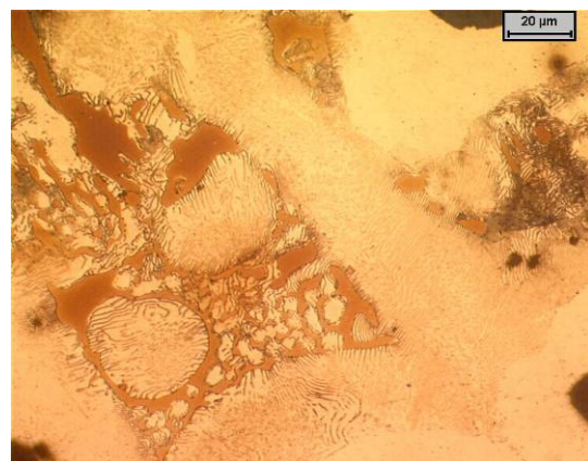
4.25. ábra. A 12-es jelű minta fénymikroszkópos felvétele 20 másodperces maratás után (Eredeti nagyítás: 500x, Beraha Na-Mo I. reagens)
