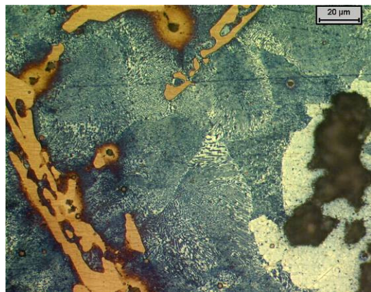
4.20. ábra. A 15-ös jelű minta fénymikroszkópos felvétele 20 másodperces maratás után (Eredeti nagyítás: 500x, Beraha CdS reagens)
