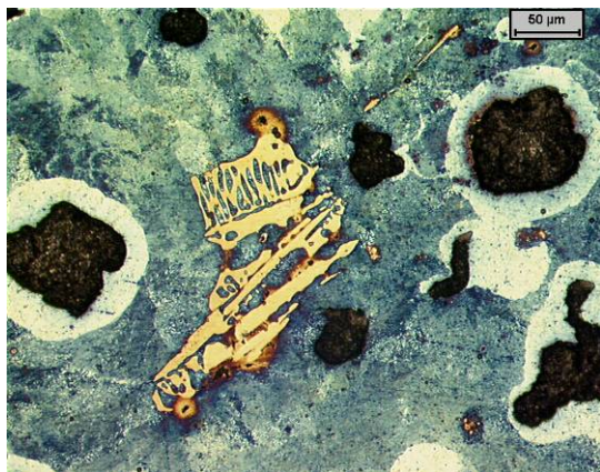
4.19. ábra. A 15-ös jelű minta fénymikroszkópos felvétele 20 másodperces maratás után (Eredeti nagyítás: 200x, Beraha CdS reagens)
