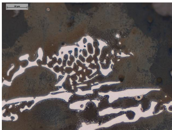
4.12. ábra. A 12-es jelű minta fénymikroszkópos felvétele 25 másodperces maratás után (Eredeti nagyítás: 500x, nátrium-metabiszulfid reagens)
