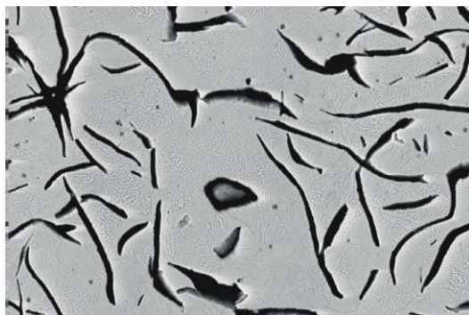
3.2. ábra. Lemezgrafitos öntöttvas pásztázó elektronmikroszkópos felvétele (visszaszórt elektron=BSE, eredeti nagyítás: 500x) [14]
