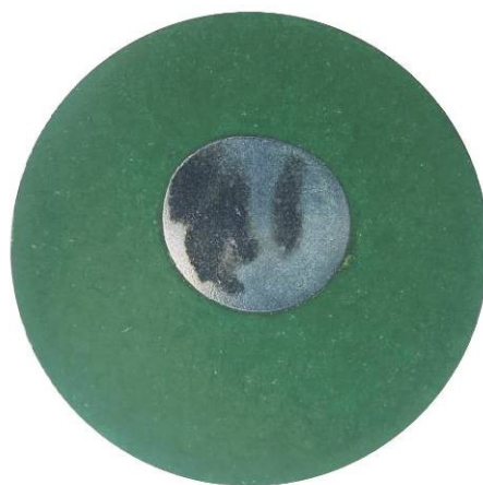
4.6. ábra. A 12-es jelű minta makroszkópos felvétele 15 másodperces maratás után (kálium-metabiszulfid reagens)
