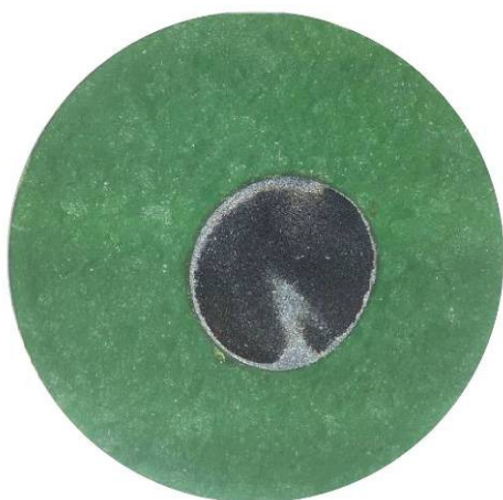
4.9. ábra. A 12-es jelű minta makroszkópos felvétele 20 másodperces maratás után (nátrium-metabiszulfid reagens)
