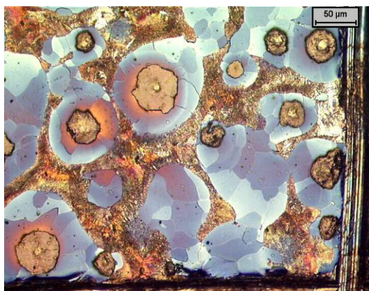
4.35. ábra. A 16-os jelű minta vizsgált látóteréről készült fénymikroszkópos felvétel négy és fél perces maratás után (Eredeti nagyítás: 200x, Klemm I-Beraha 10/3 reagens)
