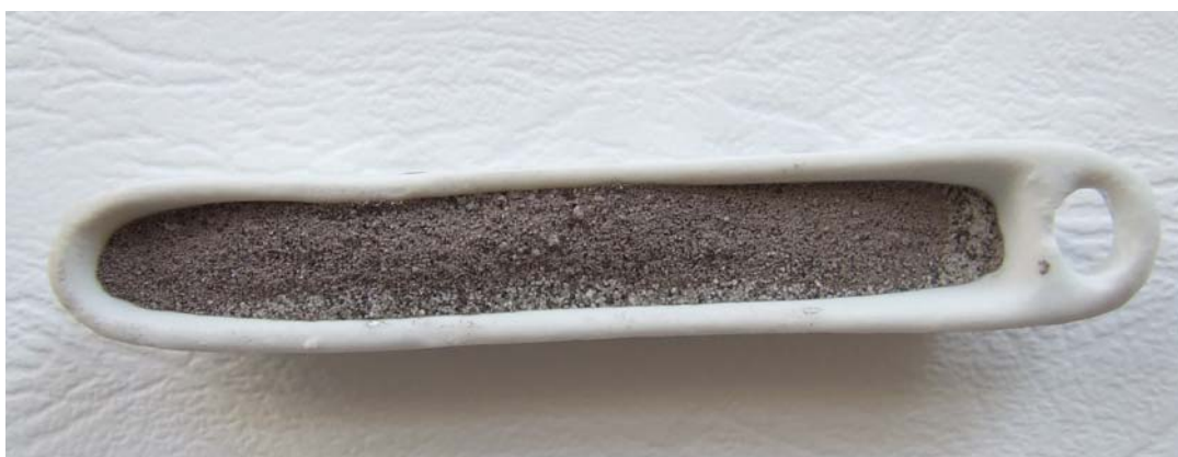
60. ábra A salakkeverékek előkészítése olvasztáshoz kerámiacsónakban
