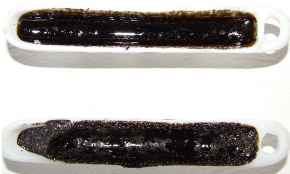
63. ábra \text{BaCl}_2 -dal dúsított (felső kép) és \text{BaSO}_4 -tal dúsított (alsó kép) üvegesített salakok
