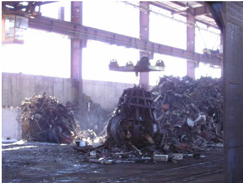
2. ábra Az acélgyártó ívkemence fémes betétje
