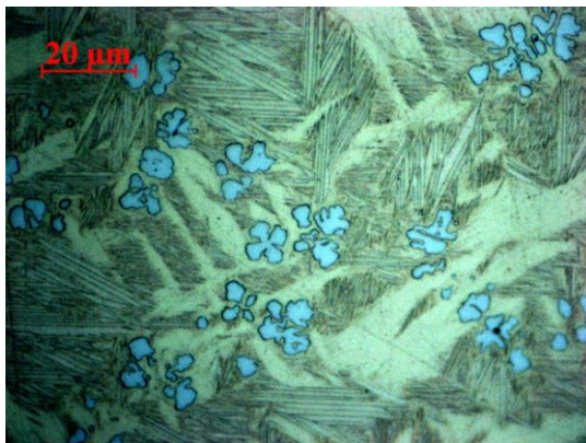
55. ábra A 600°C-on 2 óráig hőkezelt minta szerkezete. N=3200X
