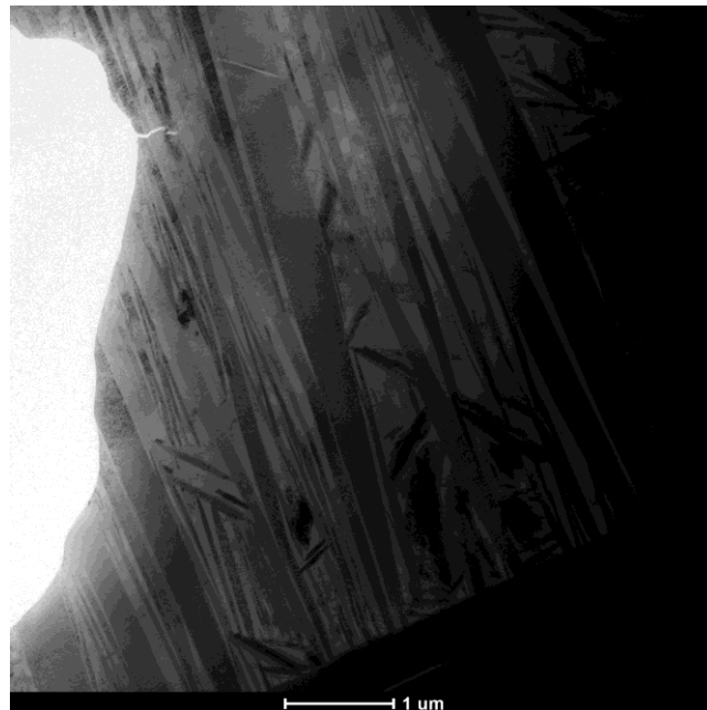
89. ábra Az öregített CuAlNiMn ötvözet TEM képe
