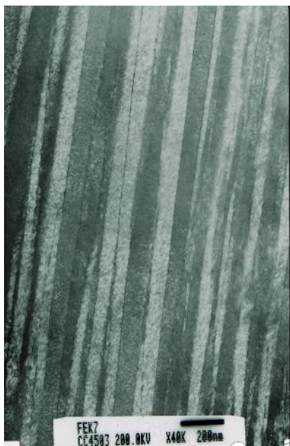
87. ábra A CuAlNiMnFe ötvözet termoelasztikus martenzitjének TEM képe 40.000X nagyításban
