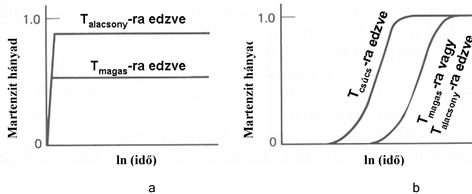
10. ábra Az a) atermikus és a b) termikus martenzites átalakulás kinetikai diagramja [1]
