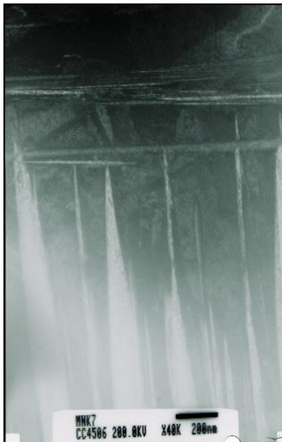
85. ábra A CuAlNiMn ötvözet thermoelasztikus martenzitjének TEM képe, 40.000X nagyításban
