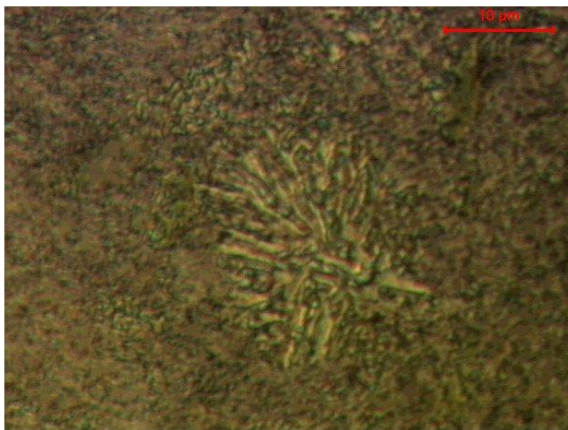
58. ábra A 420°C-on 20 óráig kemencében hőkezelt minta elfaiult morfológiájú eutektoidia.
