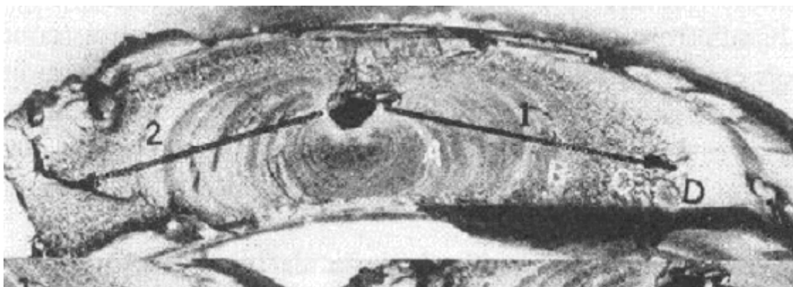
12. ábra: Polietilén cső fáradásos repedésterjedése
