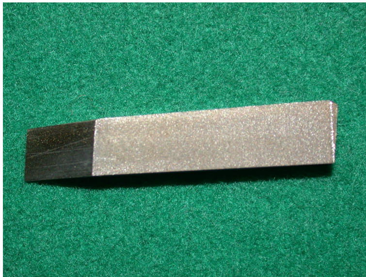
79. ábra magkristály a szikraforgácsolás után
