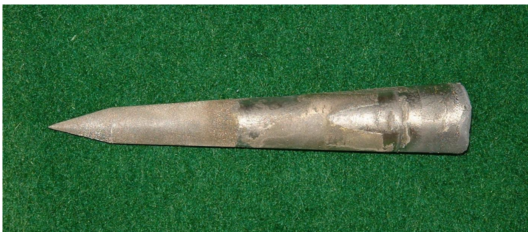
68. ábra A darab a kristályosítás után
