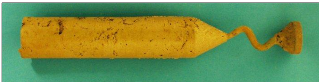
61. ábra: Salétromsavban való maratás után a polikristályos darab
