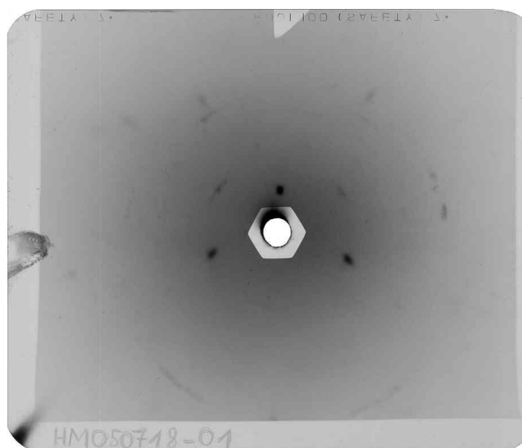
3.5. ábra A darab testéről készült Laue-felvétel
