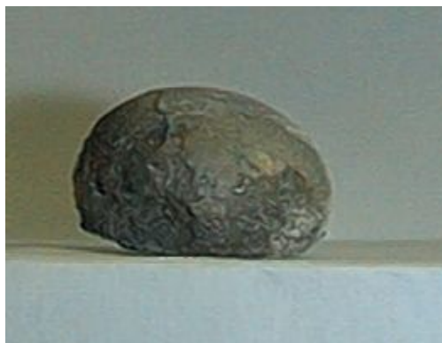
4-15. ábra Megszilárdult alumínium csepp fényképe (szénüveg tégely, NaCl-KCl-10 m/m% K_2SiF_6 sóolvadék, 700°C)
