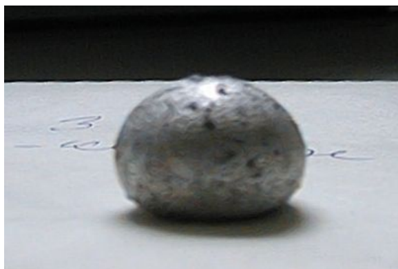
4-11. ábra Megszilárdult alumínium csepp fényképe (szénüveg tégely, NaCl-KCl sóolvadék, 700°C)
