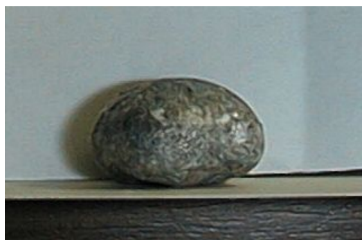
4-16. ábra Megszilárdult alumínium csepp fényképe (szénüveg tégely, NaCl-KCl-10 m/m% MgCl_2 -NaF sóolvadék, 700 °C)
