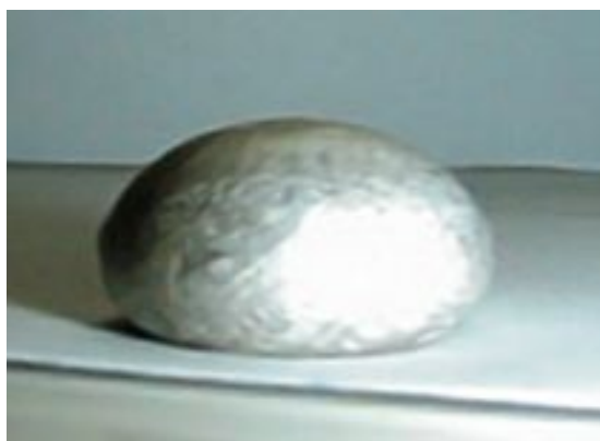
4-12. ábra Megszilárdult alumínium csepp fényképe (szénüveg tégely, NaCl-KCl-10 m/m% NaF sóolvadék, 700°C)
