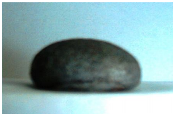
4-14 ábra Megszilárdult alumínium csepp fényképe (szénüveg tégely, NaCl-KCl-10 m/m% CuCl_2 -NaF sóolvadék, 700°C)
