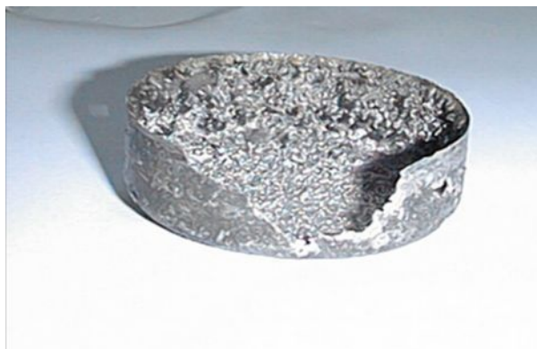
4-13. ábra Megszilárdult alumínium fényképe (szénüveg tégely, NaCl-KCl-10 m/m% K_2TiF_6 sóolvadék, 700°C)
