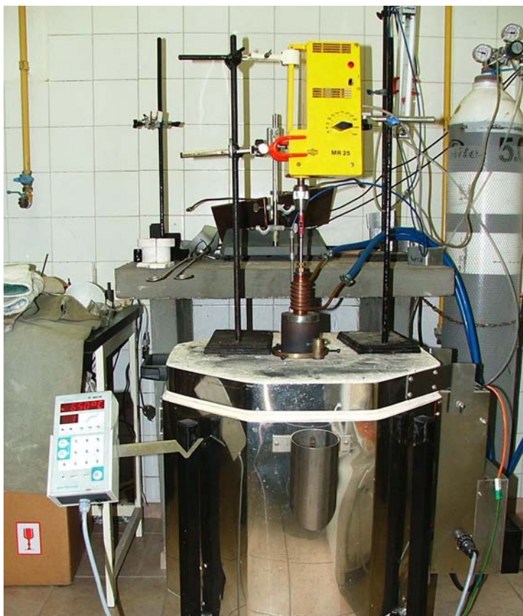
1. ábra: A szemcsékkel stabilizált monotektikus ötvözetek fejlesztéséhez használt berendezés-együttes fényképe
