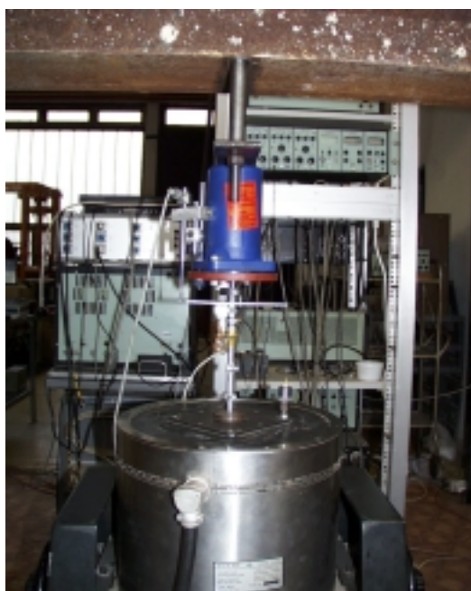
3.5. ábra Biztonsági szelep rezgetővizsgálata
