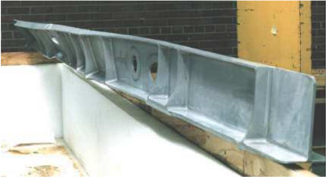
2.4 ábra Edző hőkezelés során deformálódott alkatrész [5]
