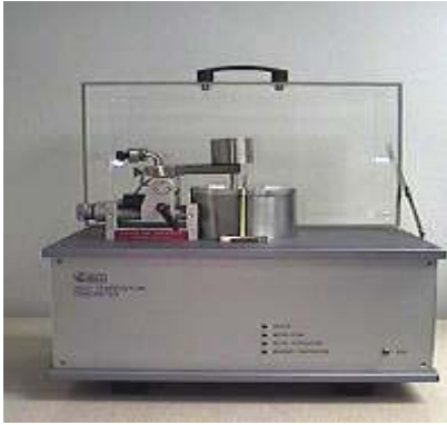
27. ábra THT-S-AX-0000 típusú tribométer
