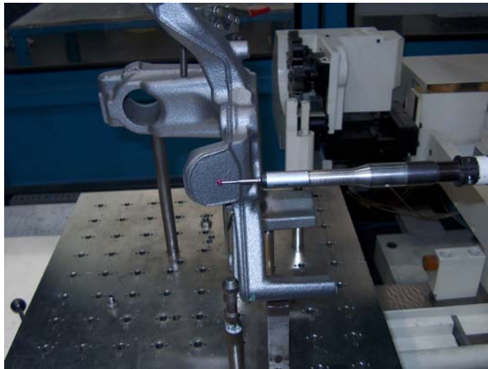
40. ábra 3D letapogatásos méret ellenőrzés (random test)
