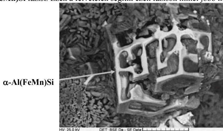
35. ábra \alpha\text{-AlFeMnSi} intermetallikus fázisról scanning elektronmikroszkópon (N=1000x) készült felvétel. (eutektikus összetételű nemesített, 0.8 % vas- és 0,4% mangán tartalmú AlSi ötvözet).
