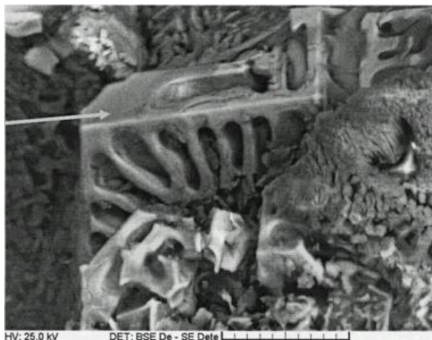
36. ábra \alpha -AlFeMnSi intermetallikus fázisról scanning elektronmikroszkópon készült felvétel, N=1500x. (hipoeutektikus összetételű nemesített, 0,8 % vas- és 0,4% mangán tartalmú alumínium-szilícium ötvözet).
