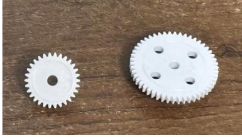
9. ábra: Az összehasonlításhoz használt fröccsöntött fogaskerekek
