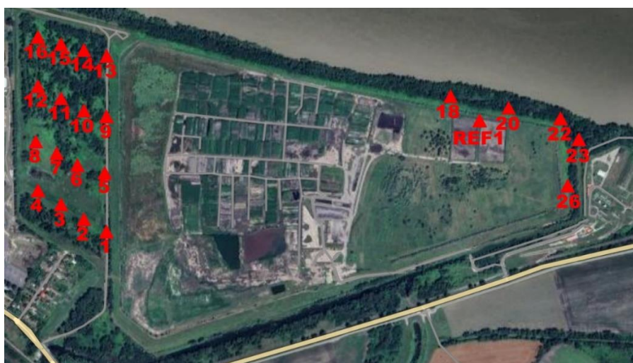
30. ábra: A geoelektromos mérések elhelyezkedése a zagytározó környezetében (szerző saját szerkesztése)
