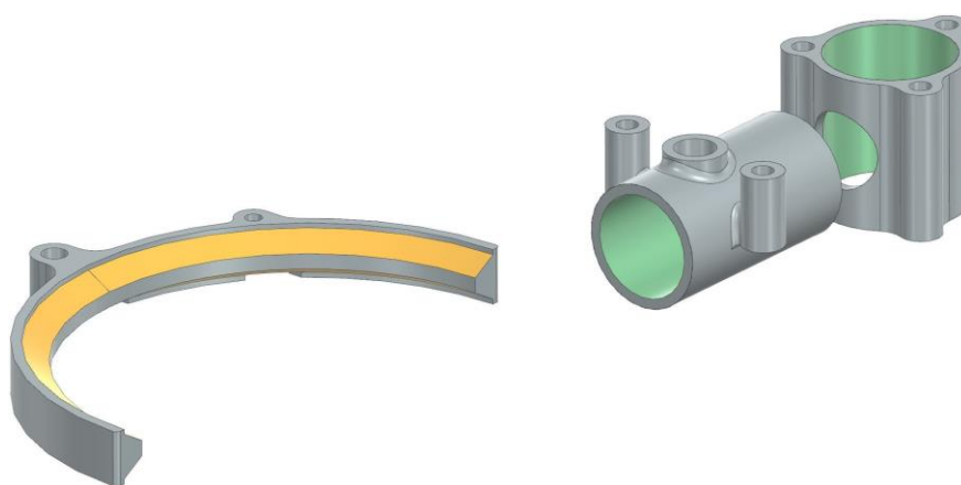
26. ábra. A szerszámváltó kar terheléseinek kontakt felületei
