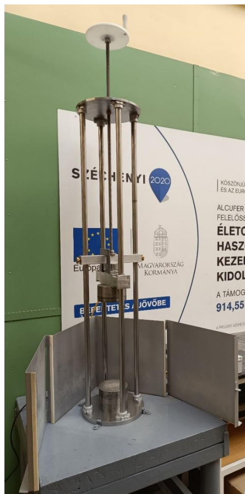
18. ábra: Esősúlyos berendezés második, továbbfejlesztett konstrukciója
