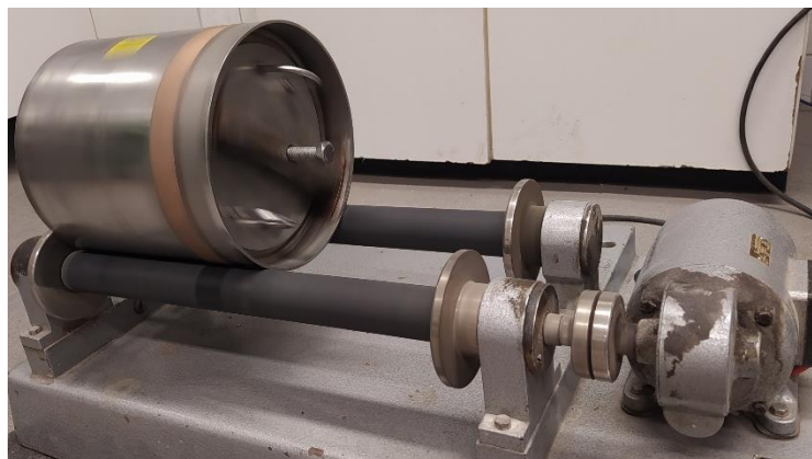
154. ábra: MSZ EN 1097-1 szabvány szerinti mikro-Deval berendezés (Szerző saját felvétele)
