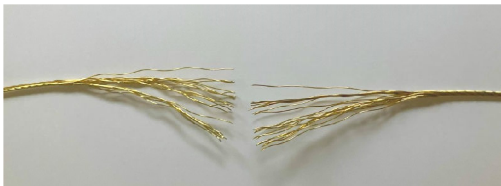
8. ábra A vizsgált acélsodronyok jellegzetes szakadási képe (Ø3.6C)
