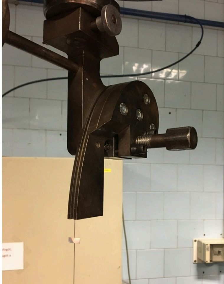
6. ábra A huzalminták szakítóvizsgálatához alkalmazott speciális befogó
