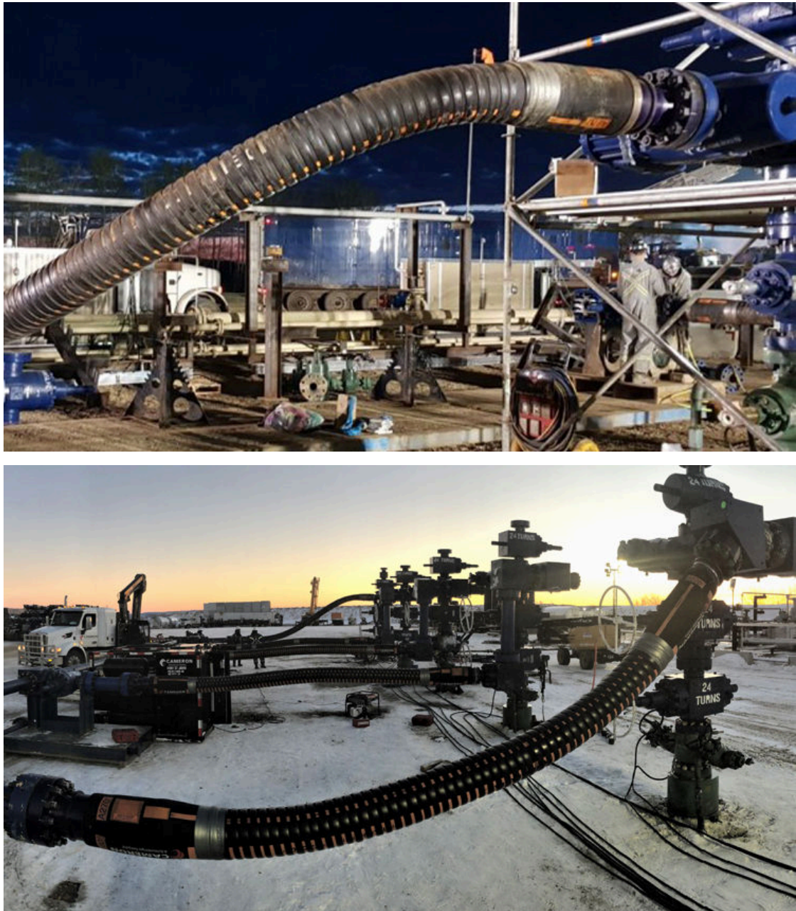
27-28. ábra Hidraulikus rétegrepesztő tömlők működés közben, a repesztő nyomást előállító szivattyú és az olajkútfejek között beszerelve (NA150, PN=1035 bar)
