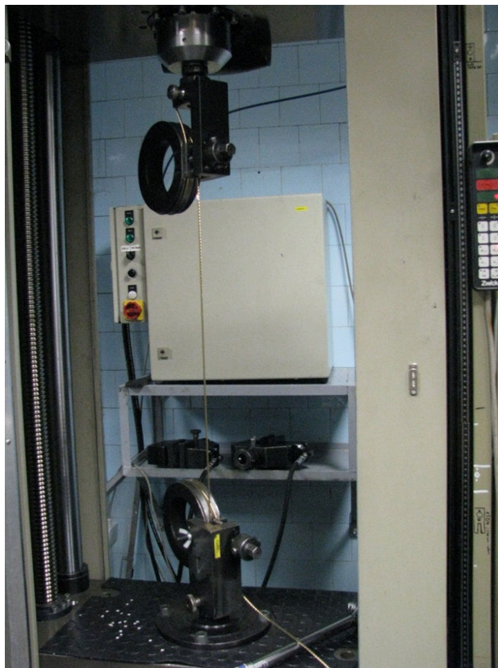
7. ábra A sodronyminták szakítóvizsgálatához alkalmazott csigás befogó
