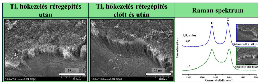
C. ábra: Titán szubsztráton a rétegépítés során egyszer (után) és kétszer hőkezelt (előtt és után) hőkezelt katalizátor rétegen előállított CNT erdők SEM felvétele és Raman spektruma
