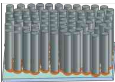
3. ábra: Függőlegesen rendezett szén nanocső sematikus ábrája
