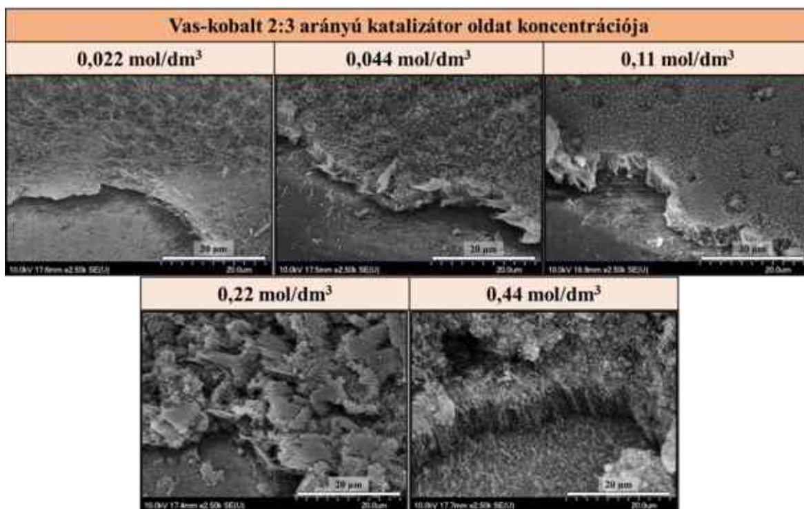
16. ábra: AZO szubsztráton 650 °C-on, Al 2 O 3 hordozóréteg jelenlétében, vas-kobalt 2:3 arányú, különböző koncentrációjú katalizátor oldat alkalmazásával szintetizált függőlegesen rendezett szén nanocsövek SEM felvételei
