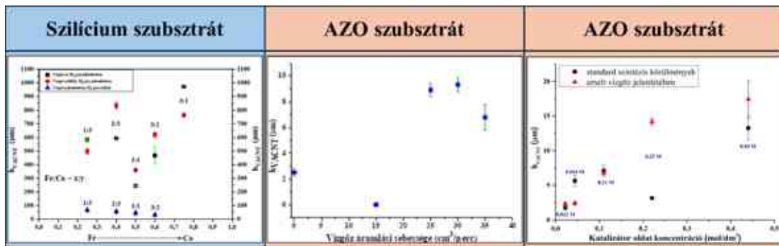
G. ábra: Szilícium és AZO szubsztráton előállított CNT erdők meghatározott magasságnak értékei, AZO-nál vízgőz áramlási sebességének függvényében, valamint emelt vízgőz áramlási sebesség mellett különböző vas-kobalt katalizátor koncentráció mellett, szilícium esetében vízgőz jelenlétében és vízgőz nélkül
