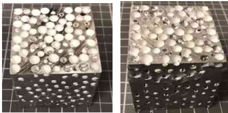
16. ábra Zömítés előtti(balra) és utáni (jobbra) felvételek a 4:1 keverékű fémhabról.
