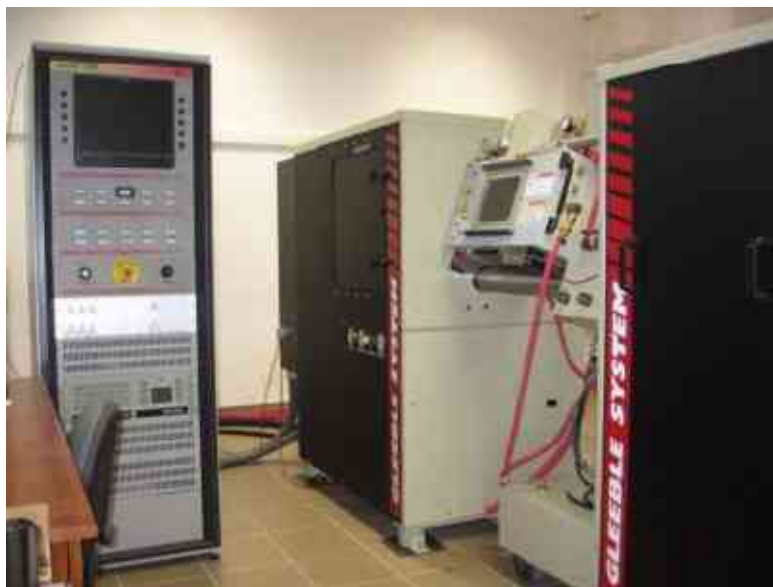
15. ábra. A Gleeble 3500 termomechanikus szimulátor a Miskolci Egyetem Anyagszerkezet-tani és Anyagtechnológiai Intézetében [28]
