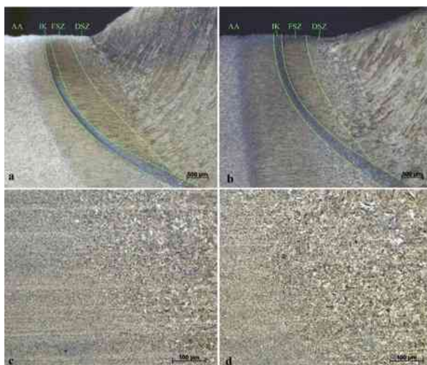
36. ábra. A hegesztett kötés optikai mikroszkópos képei az S1300Q anyagminőség esetén, maratás: 3% \text{HNO}_3
