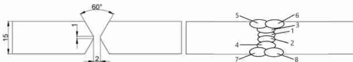
33. ábra. A kötés kialakítás és a varratsorok sematikus ábrája az S1100M anyagminőség esetén
