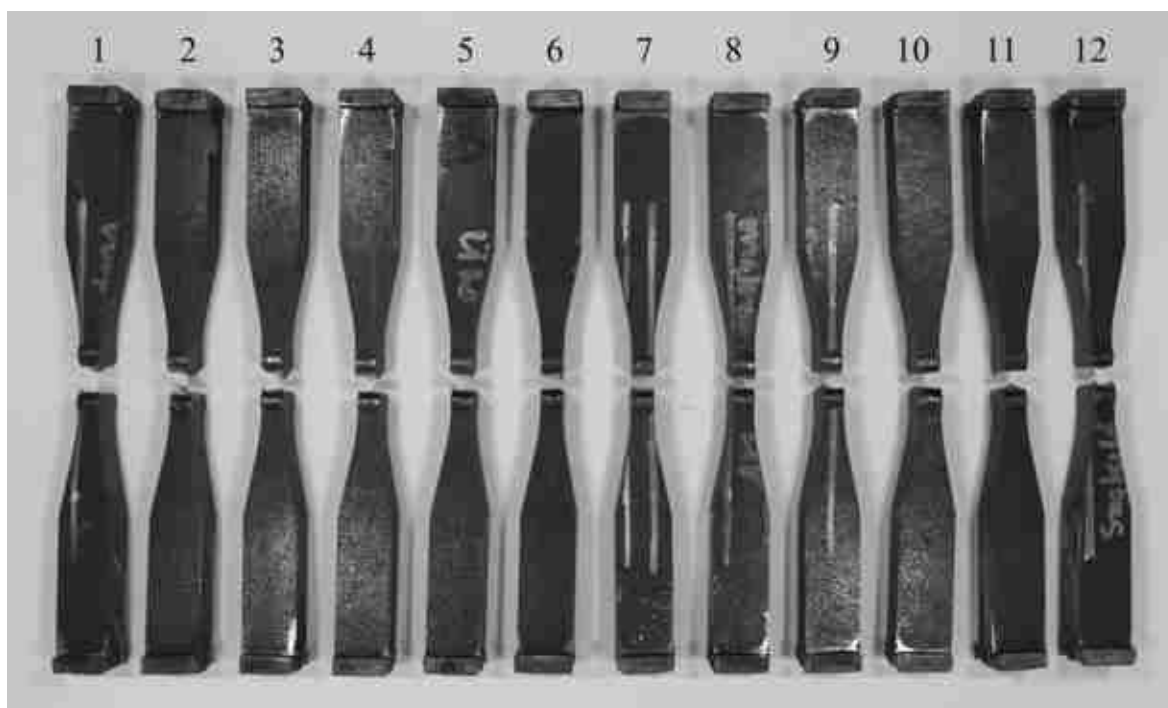
M3.2. ábra. Az S1100M alapanyagban a Böhler Union X96 hozaganyaggal létrehozott kötésekből készült próbatestek a nagyciklusú fárasztóvizsgálatok után
