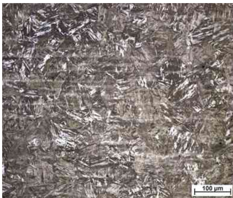
20. ábra. Az S1300Q alapanyag szövetszerkezete, N = 200x, maratás: 3% HNO 3
