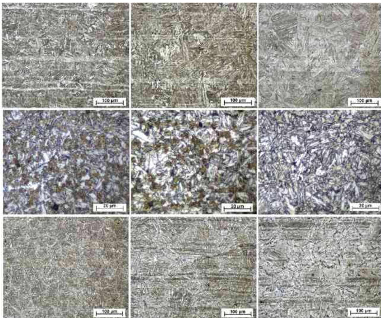
27. ábra. Az S1300Q anyagminőségről készült képek a durvaszemcsés, az interkritikus és az interkritikus durvaszemcsés hőhatásövezeti sávokban t_{8/5} = 5, 15 és 30 s esetén, maratás: 3% \text{HNO}_3
