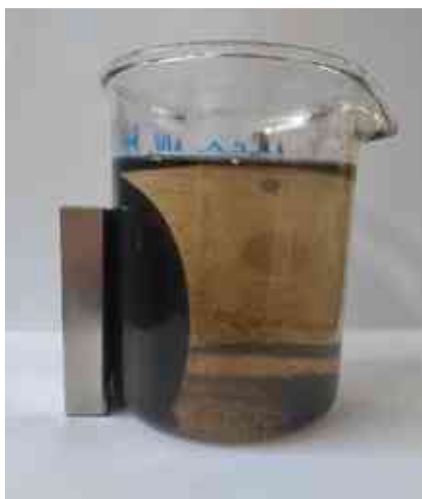
9. ábra: Mágnesezhető részecskék elválasztása mágnes segítségével
