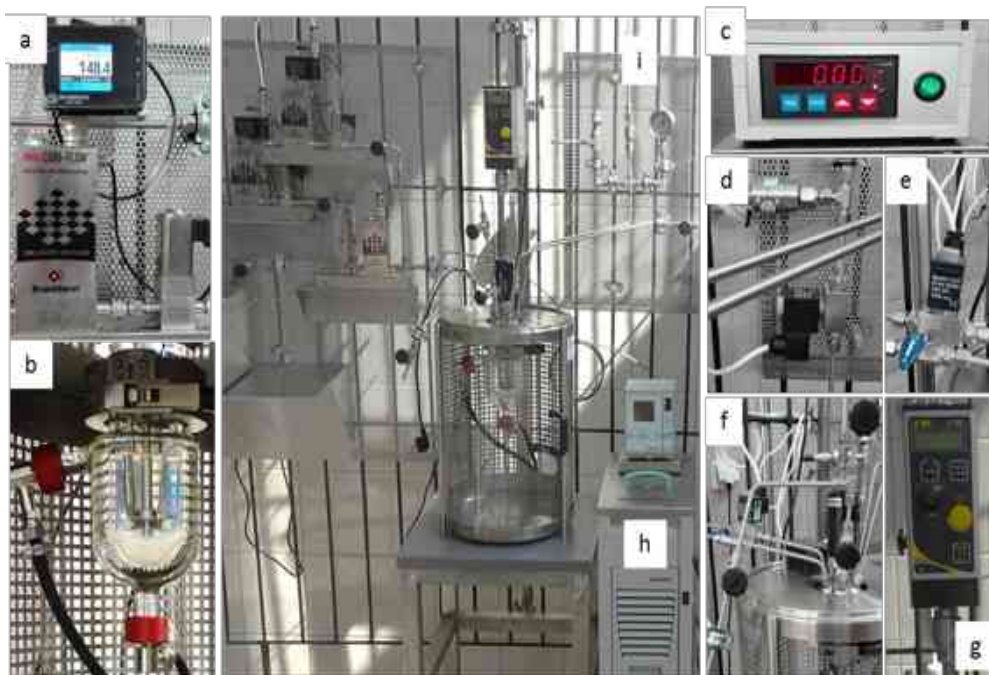
14. ábra: a) áramlásszabályzó, b) reaktor c) nyomásszabályzó, d) e) mágnes-szelepek f) minta-adagoló rendszer, g) keverő, h) hőmérséklet szabályzó
