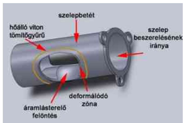
28. ábra: Szelepbetét konstrukciós jellemzői
