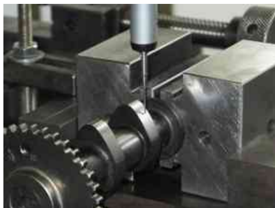
43. ábra: Szívószelep vezérműbüttyök mérése koordináta mérőgépen a szentesi Legrandnál
