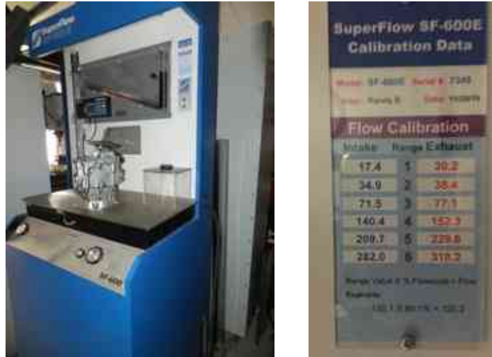
36. ábra: SuperFlow SF6-600 áramlásmérő berendezés az ülékes szeleppel szerelt hengerfej mérése közben, valamint a készülék előlapján található kalibrációs tábla
