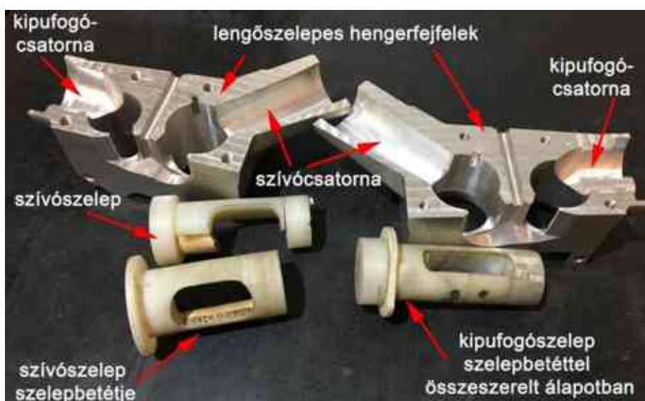
62. ábra: Áramlástanai vizsgálatok céljából készített lengőszelepes hengerfej és részei szétszerelt állapotban
