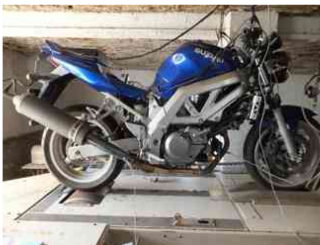
39. ábra: Suzuki SV650 motorikus jellemzőinek meghatározása a görgős teljesítménymérő padon
