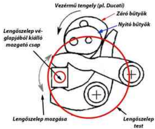
30. ábra: Lengőszelep lehetséges vezérlése desmodromikus elrendezésű bütyköstengellyel.
