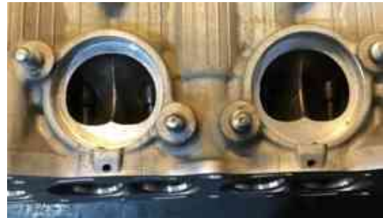
49. ábra: Kipufogócsatornában kialakított visszaáramlás korlátozó megoldások:
