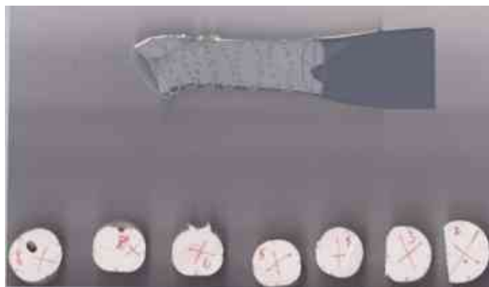
58. ábra: Szívócső szilikonumi szeletei scannelés után, valamint a körvonalrajzok elhelyezése a felület kialakítás fázisában
