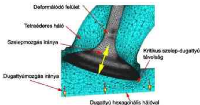
80. ábra: Dinamikus hálózás során elhelyezkedése az üléses szeleppel szerelt modellben alkalmazott határfelületek, elhelyezkedésük és a kialakuló cellaütközés helyzete
