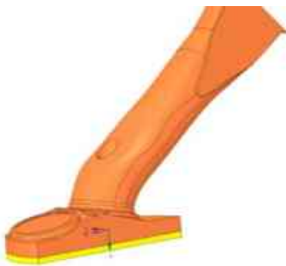
75. ábra: Ülékes szelep áramlási modell előkészítési szakasza, hálótípusnak megfelelő térfogatokra osztása
