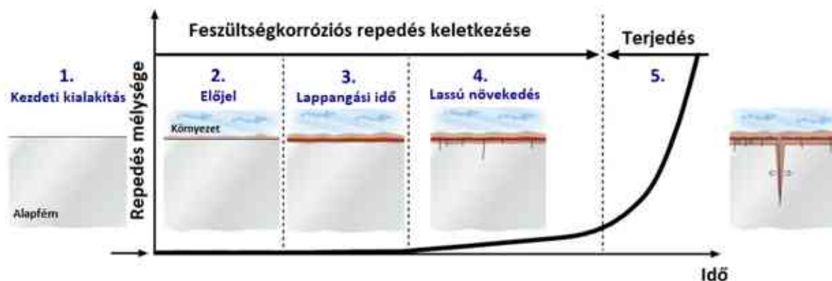
1.8. ábra. Feszültségkorróziós repedés szakaszai
