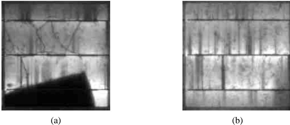
59. ábra. (a) Széles törés által okozott, teljesen levált cellatöredék; (b) példák elektróda hibákra.
