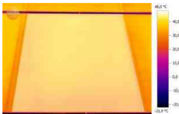
36. ábra. Egy működésképtelen modul hőkamerás képe.
