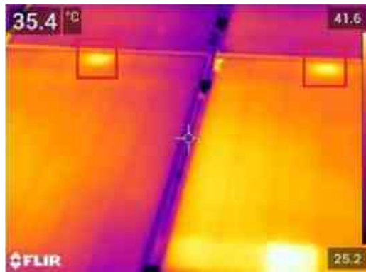
41. ábra. A napelemmodulok kapcsolódobozainak melegedése.
