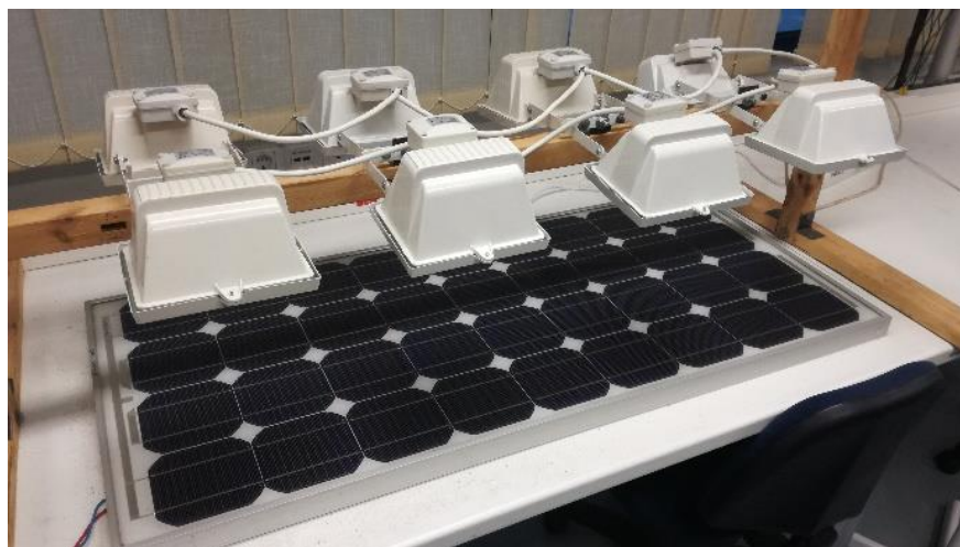
2. ábra. A napszimulátor által megvilágított napelempanel.
