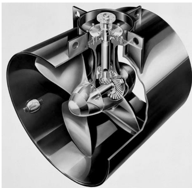
2.4. ábra. Hajócsavar (propeller) hajtása [KLI16]
