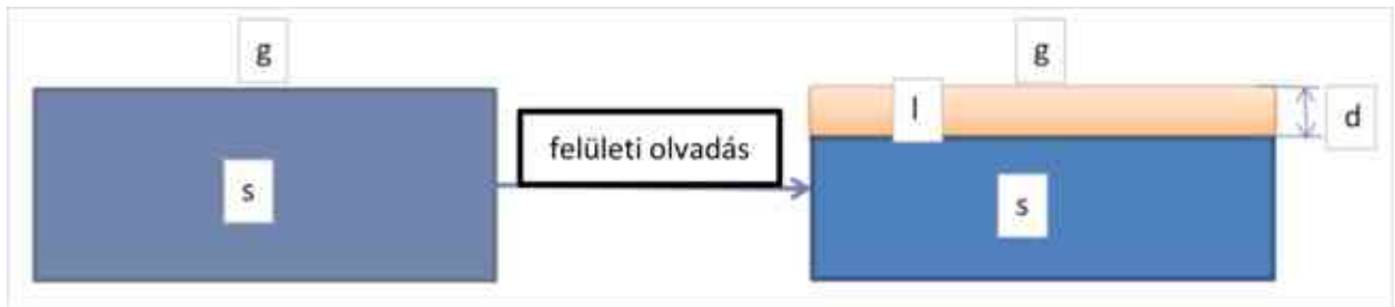
3.1. ábra: A makroszkopikus kristály felületi olvadásának sematikus ábrája [2]
