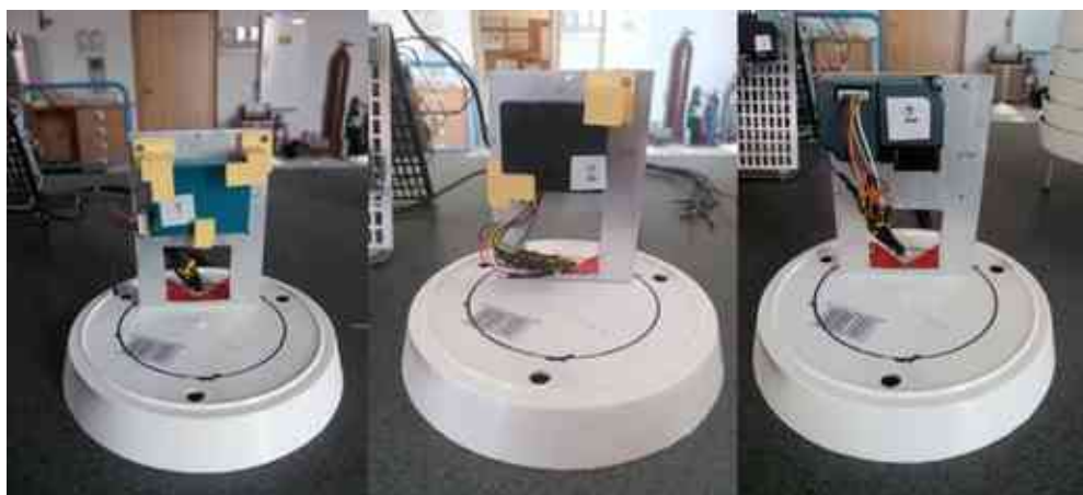
36. ábra Védőburkolat alja és a szenzorok rögzítési módja
