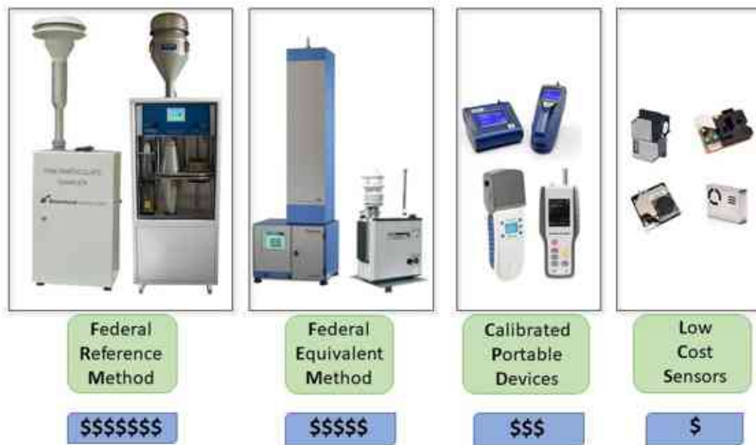
2. ábra Szálló por mérő berendezések és nagyságrendi áruk
