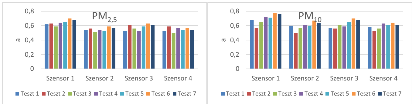
50. ábra Meredekség értékek szenzoronként és tesztenként a PM 2,5 és PM 10 esetében
