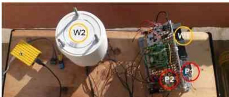
40. ábra Plantower és Winsen szenzorok helyzete a 11. számú mérés alatt 18:56 és 20:12 között
