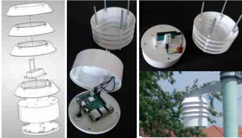
27. ábra Mérőegység háza, össze-, és felszerelése
