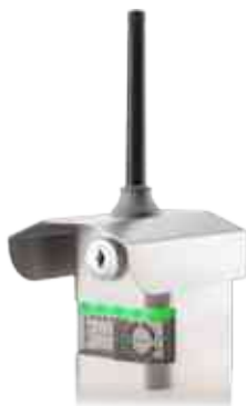
10. ábra Az Airly PM szenzorral szerelt mérőegysége [111]
