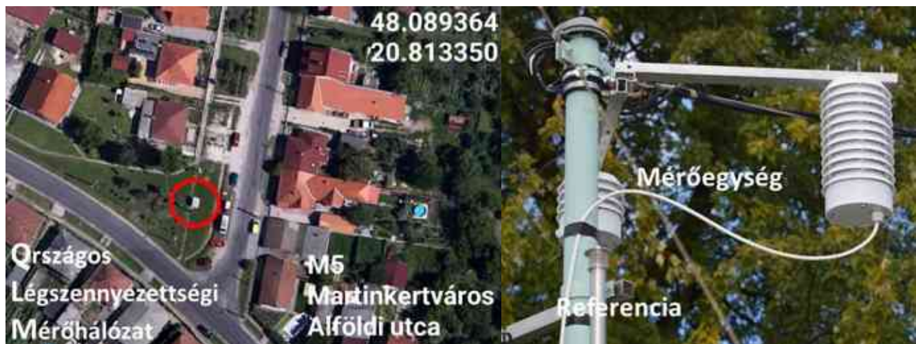
57. ábra Az összemérés helyszíne és a mérőegység, valamint referencia eszköz beszívó csonkja
