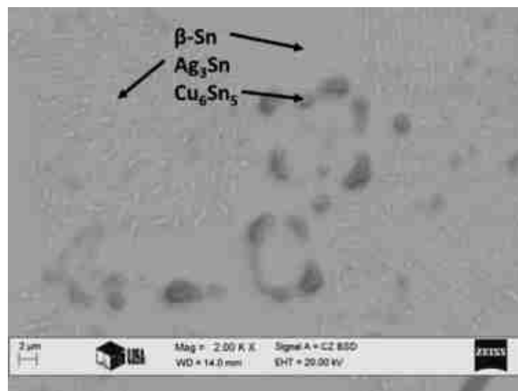
4.5. ábra. SAC305 forrasztóanyag SEM felvétele.
