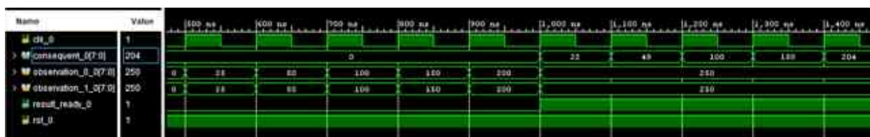
58. ábra Pipeline működést szemléltető szimuláció
