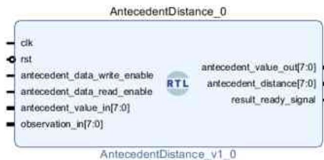
49. ábra Az AntecedentDistance modul blokk-rajza
