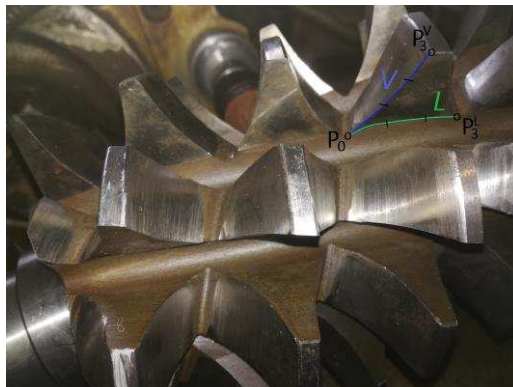
4.6.1. ábra A lefejtőmaró-fog homloklületének L lábhenger pontjai és V vágóéle[Á-14]
