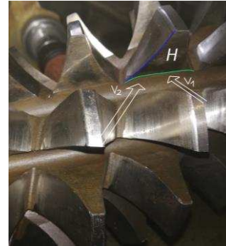
4.6.4.b. ábra A H homlokfelület és a v_1, v_2 vetítési irányok
