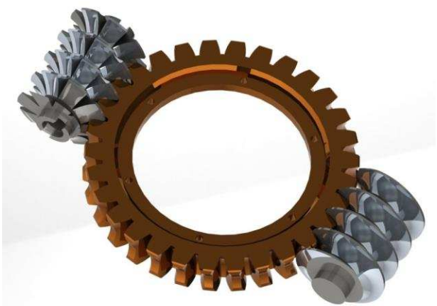
4.2. ábra A tengelymetszetben körív profilú csiga a kapcsolódó kerékkel és azt megmunkáló csigamaróval [Á- 2]
