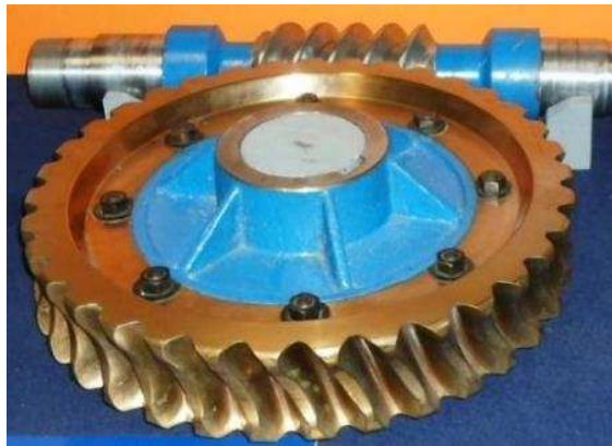
6.1 ábra A szabadalmaztatott tengelymetszetben körív profilú csiga és a kapcsolódó kerék
