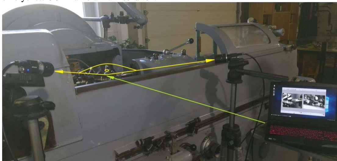
4.1.1. ábra A CCD kamerák elhelyezése és a képkiértékelés a DifiCAD Mérnökirodában található berendezésen
