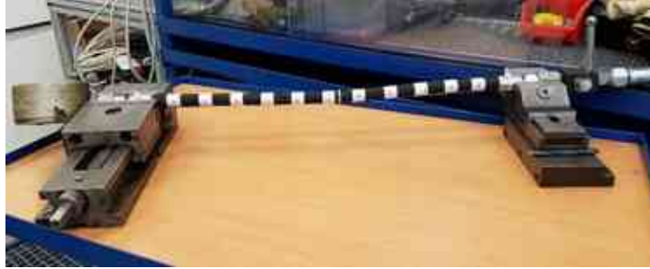
57. ábra. A fázisvezeték vizsgálatának első mérési elrendezése.
