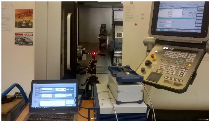
40. ábra: Az LTV mérési elrendezés
