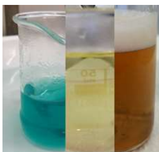
6. ábra. A NaBH 4 hozzáadását követő színváltozás a réz tartamú oldatban
