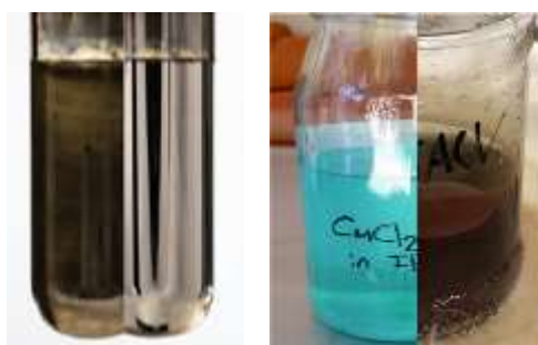
12. ábra. A \text{N}_2\text{H}_4\text{H}_2\text{O} hatása a kiinduló Ti por és \text{AgNO}_3 (bal), valamint a \text{CuCl}_2 tartalmú fürdőre (jobb)
