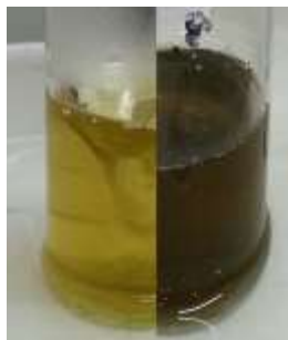
7. ábra. A hidrazin-hidrát hozzáadását követő színváltozás a nikkeltartalmú fürdőben
