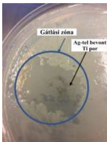
50. ábra. Az E. coli makroszkopikus növekedése az LB agarlemezen és a gátlási zóna az Ag bevonatú szivacsos Ti por körül (körrel jelölt terület)
