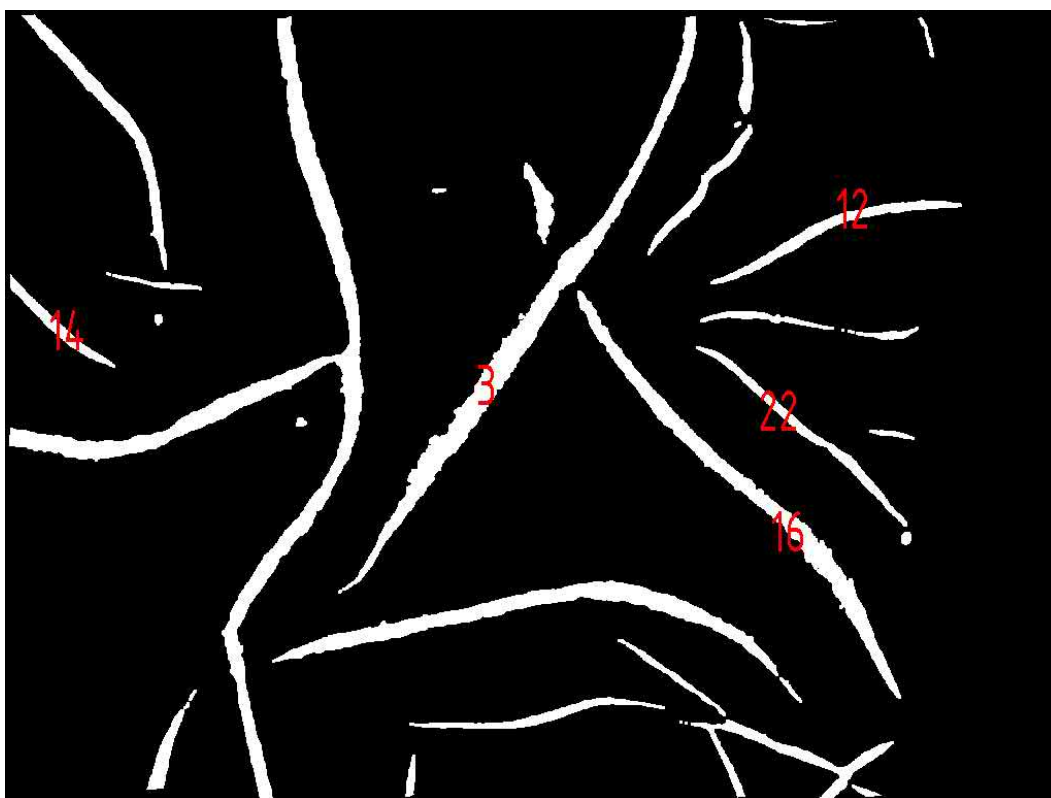
7.56. ábra: Lemezgrafitos öntöttvas, lemezes morfológiájú eutektikum tanuló képe.
