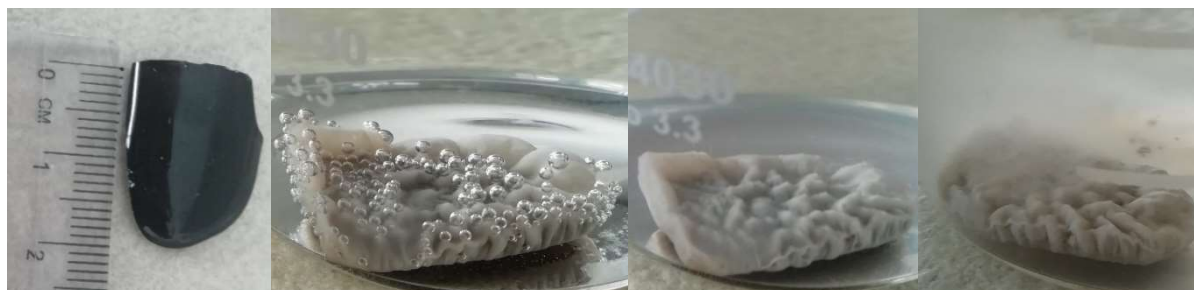
65. ábra: Poli(L-tejsav-L-borkősav) minta és hidrolitikus degradációja 3, 60 és 90 nap elteltével
