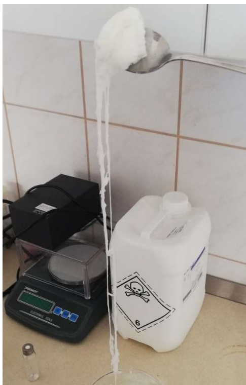
31. ábra. Szálas PLLA csapadék eltávolítása.
