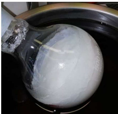
39. ábra: 150 °C-on megszilárdult PLLA a gyűrűfelnylásos polimerizáció során – 15. számú minta.
