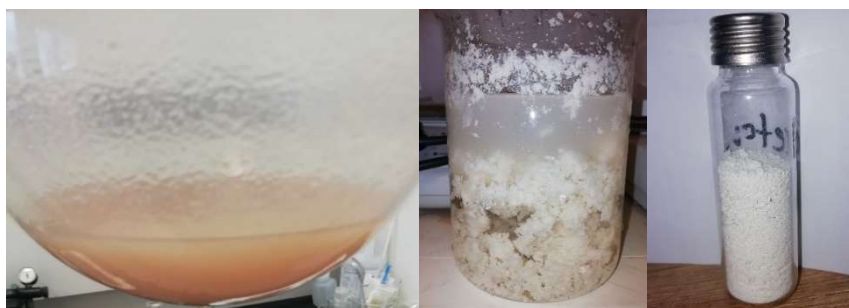
36. ábra: Acetonban oldott politejsav kicsapása.
