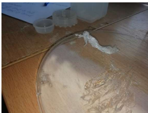
29. ábra: Az óraüvegen lehűtött kis molekulatömegű PLLA minta.
