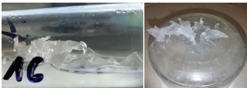
47. ábra: Oldószerben duzzadt térhálós szerkezetű PLLA.
