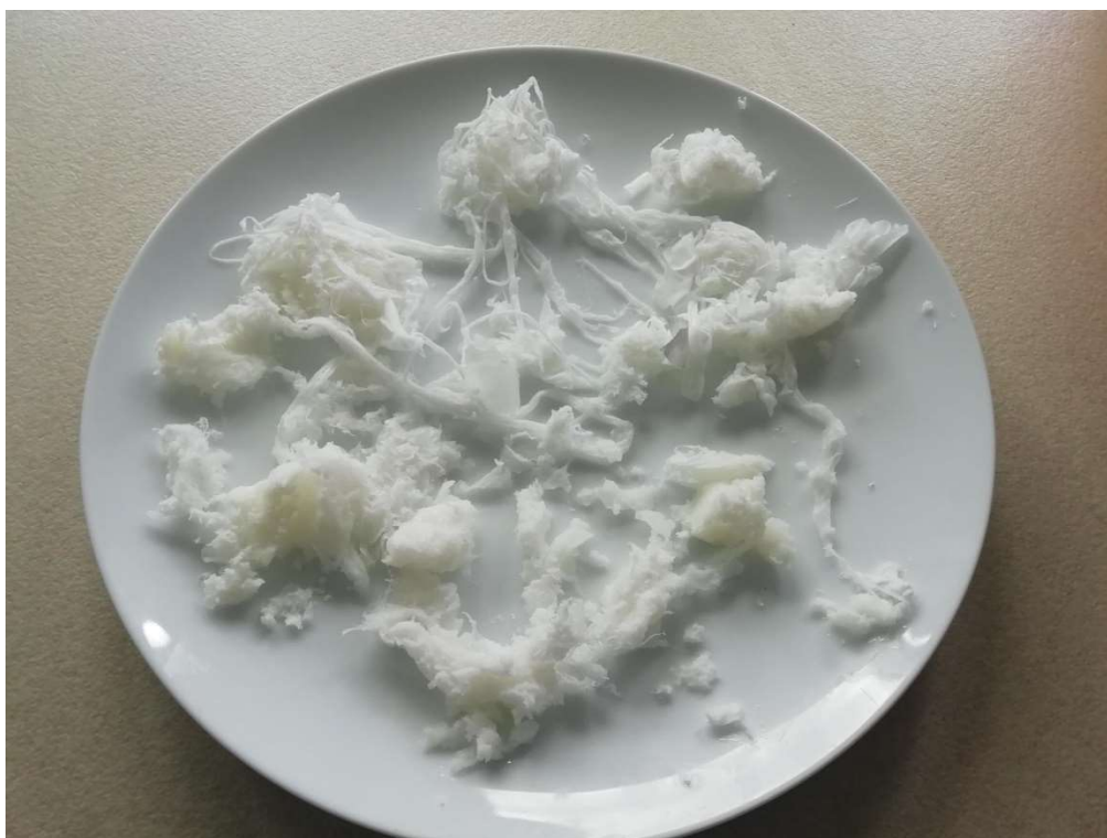
32. ábra. Lánckapcsolással előállított magas molekulatömegű PLLA.
