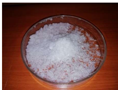
34. ábra: Petri-csészébe összegyűjtött kristályos laktid a szárítást követően.
