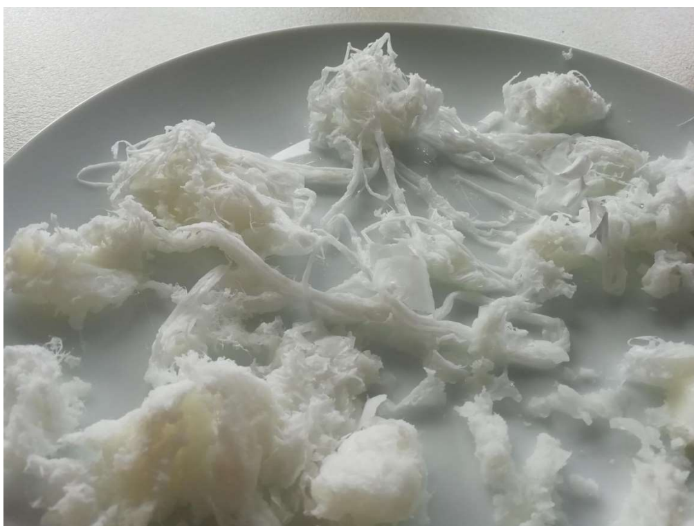
33. ábra. Lánckapcsolással előállított magas molekulatömegű PLLA szálcsapadék.
