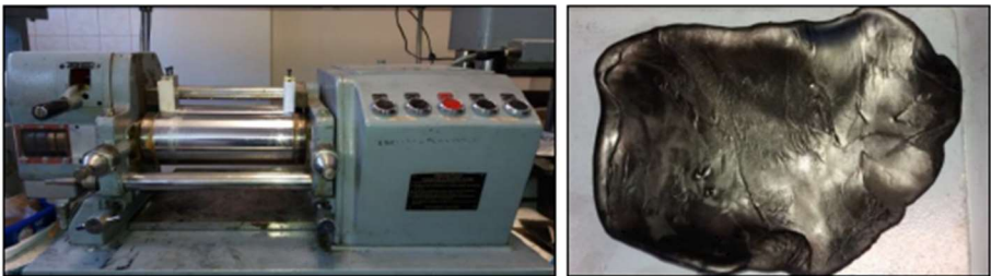
4.ábra: A laboratóriumi hengerszék, keverék és hengerelt palástja
