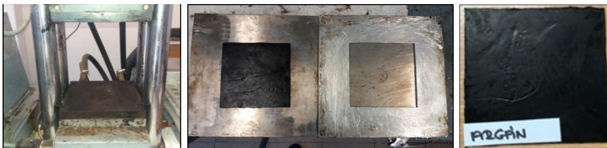
23.ábra: A présgép-, formák és egy kész próbatest
