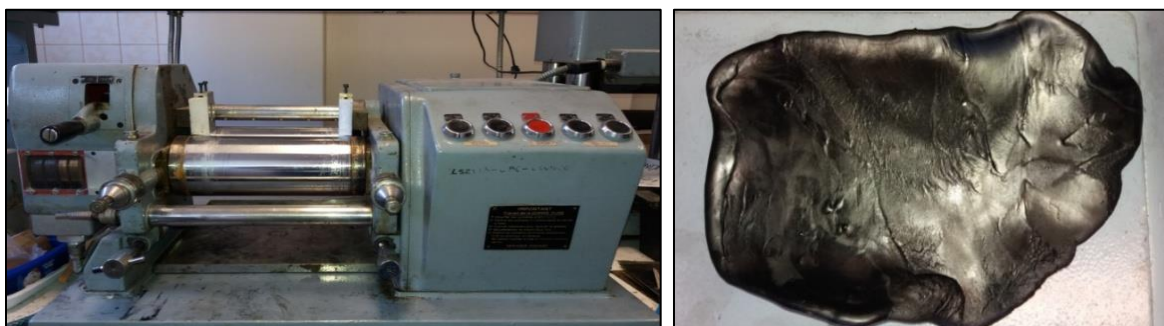
22. ábra: A laboratóriumi hengerszék, keverék és hengerelt palástja (Forrás: a szerző saját felvétele)
