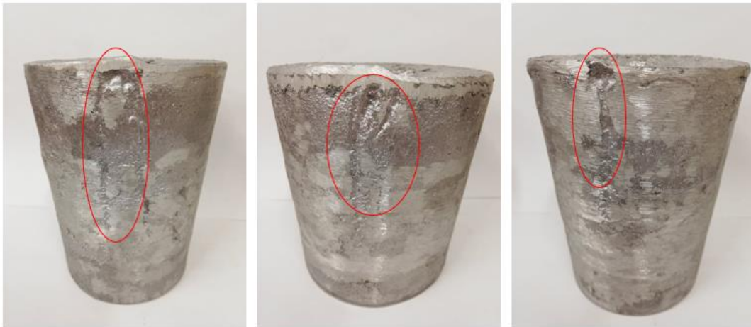
74. ábra A 90 mm átmérőjű öntvények külső kontúrján megdermedt gázhólyagok lenyomata
