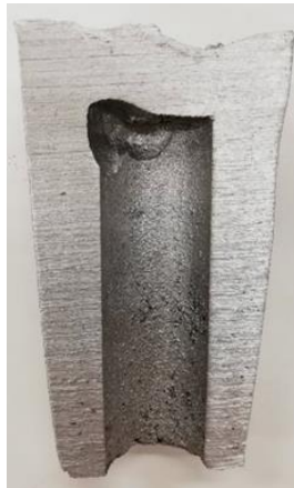
75. ábra Előkísérleti öntvényben ( h_{\text{olvadék}}=30 mm) található maggáz okozta meggörbített határfelület
