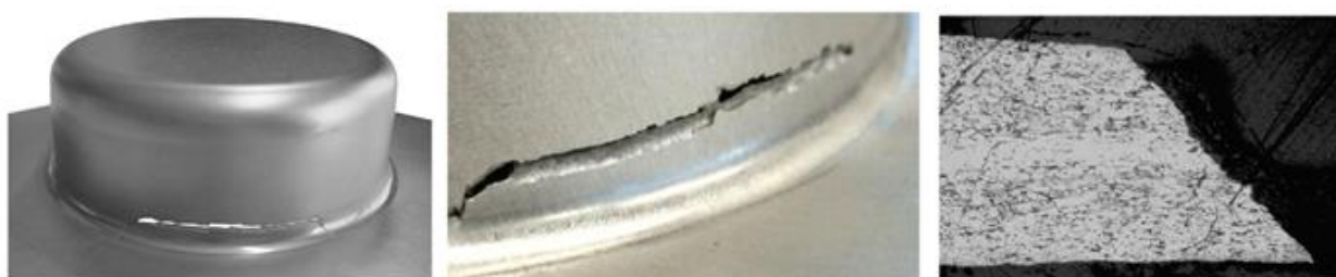
2.21. ábra. Technológiai nyíróvizsgálatnál létrejövő repedés [64]
