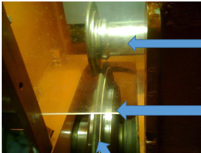
M3. 1. ábra: A meglévő korongszabályzás művelete NC vezérléssel
