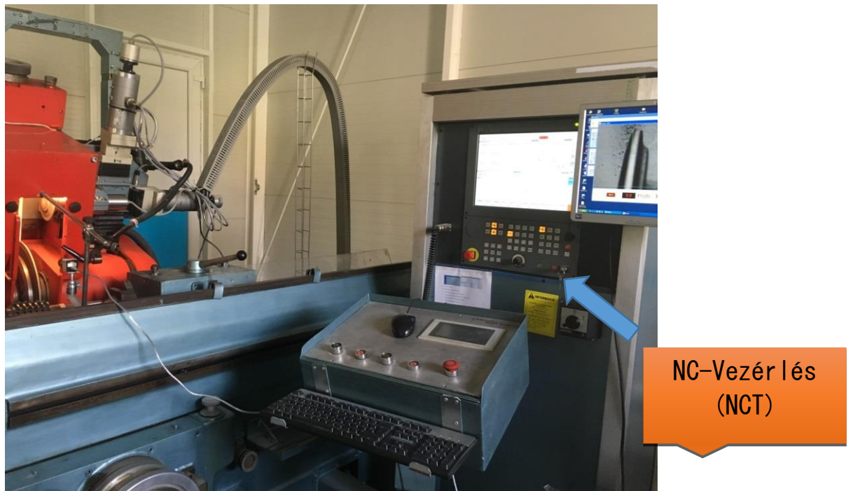
A köszörű korong szabályozó gép az NC vezérléssel felszerelve
