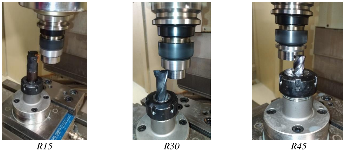
2.2. ábra. A forgácsoló szerszám felfogatása az erőmérő platformra
