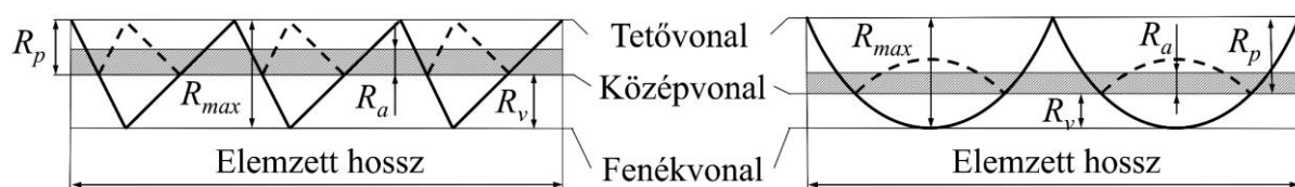
6.1. ábra. Érdességi paraméterek geometriai értelmezése hegyes és rádiuszos csúcs esetén
