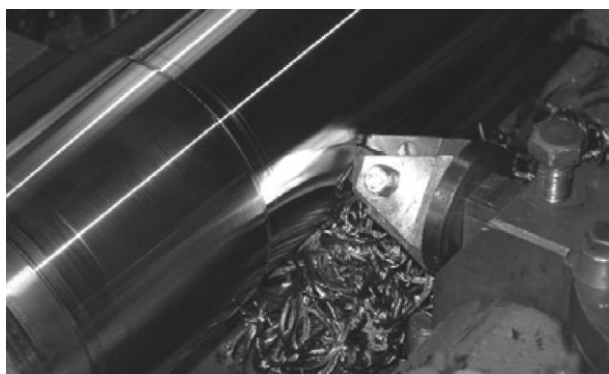
1.4. ábra. A hántoló esztergálás és kinematikai vázlata [45]
