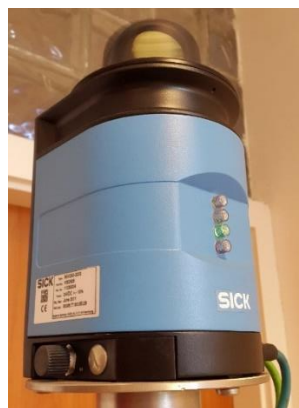
5.5. ábra: Vezető nélküli targoncán alkalmazott Sick márkájú NAV350 típusú LIDAR szenzor
