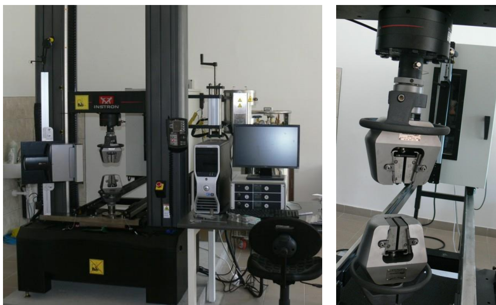
3-5. ábra Instron 5982 elektromechanikus univerzális anyagvizsgáló berendezés
