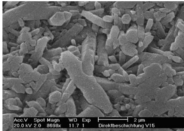
7. ábra. A \text{Si}_3\text{N}_4 - \text{Y}_2\text{O}_3 - \text{Al}_2\text{O}_3 rendszer mikroszerkezete szinterelés után.
