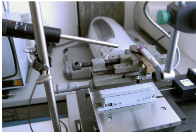
27. ábra. Stylus profilométer gyémánttűvel és a mérést segítő kamerával.
