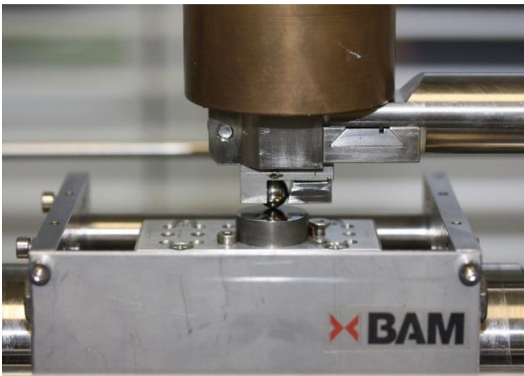
22. ábra. A mérésekhez használt tribométer a berlini BAM Kutatóintézetben.
